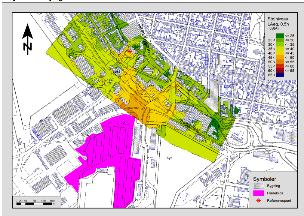
Figur 42 - Konturkort 1,5 meter over terræn fra Esbjerg Havneservice med indikation af fladekilde og referencepunkt på Willemoesgade 8.
