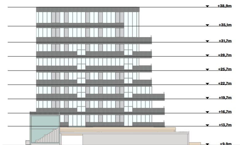
Figur 19 - Bundkoten på det nye byggeri ses at være 9,90 DVR90. Herfra er de forskellige etagers gulvkoter angivet.
