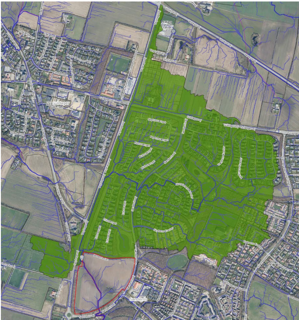
Figur 7.1: Topografisk opland til projektområde vist med grøn. Afgrænsning af projektområde vist med rød. Strømningsveje med et oplandsareal større end 0,1 ha vist med blå.
