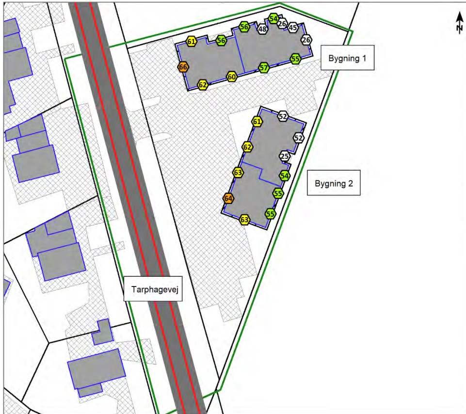
Figur 3: Facadestøjniveau for 1. sal.
