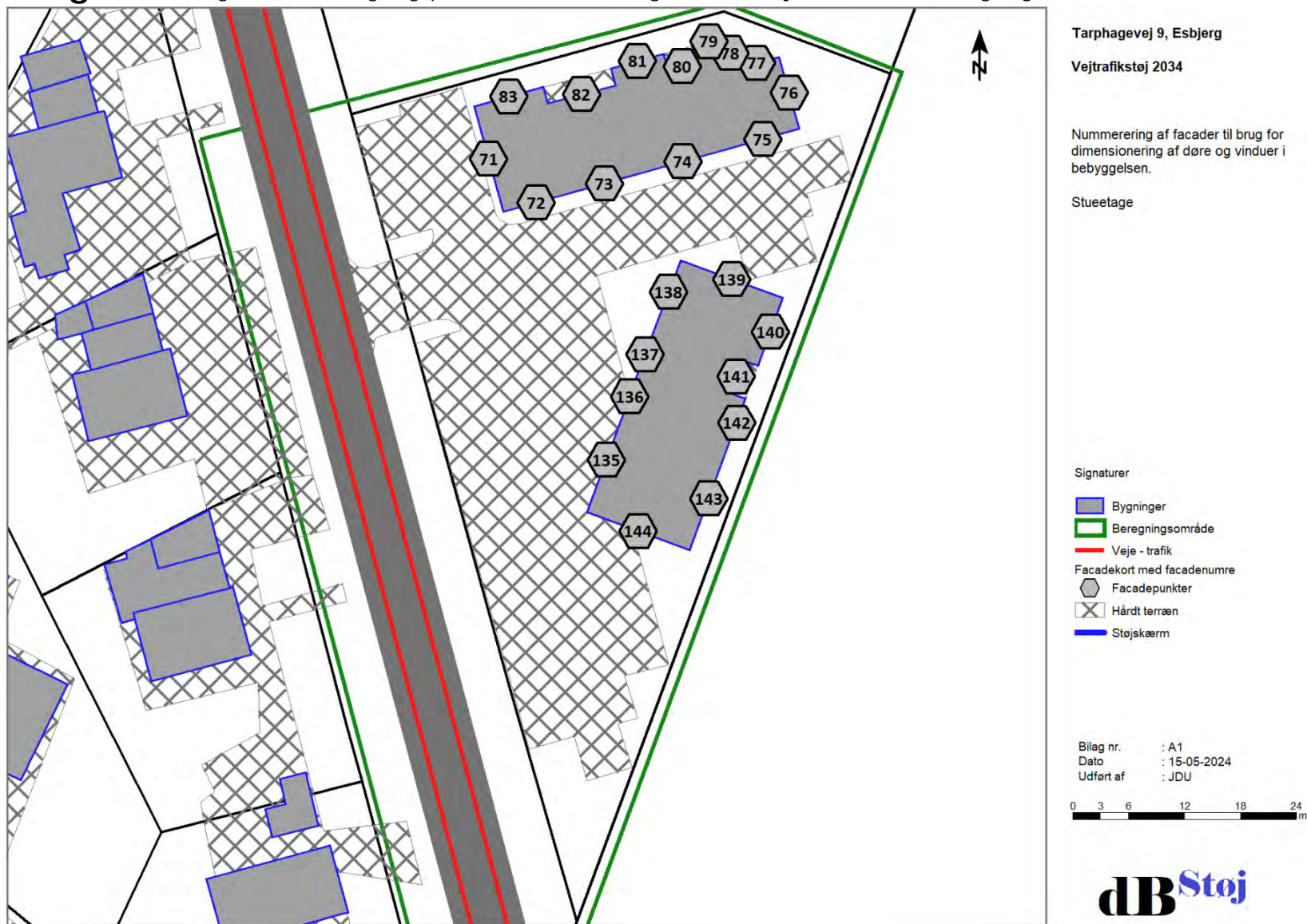
Figur 16: Facadeberegningpunkter med nummerering, stueetage.
